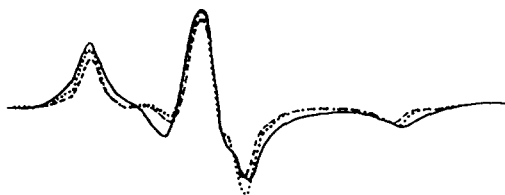
Fig. 3. Spectres de RPE des sondes dans les plaques de PVC rigide à température ordinaire. ····, 1; ---, 2; —, 3.
